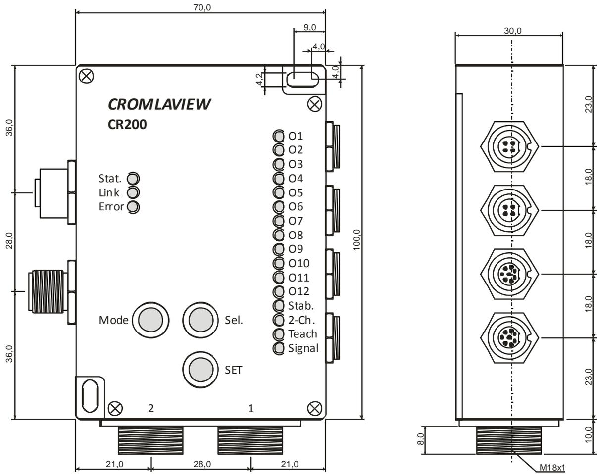
Abbildung 3 : CR200P zum Anschluss von zwei getrennten Lichtleitern
